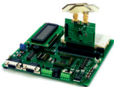
Рис. 8. Внешний вид платы «RF Daughter Card (13192RFC-A00)» и отладочного комплекта «MC9S08GB60 Evaluation Board»
