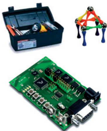
Рис. 7. Внешний вид отладочного комплекта «Developer's Starter Kit (13192DSK-A00)»
