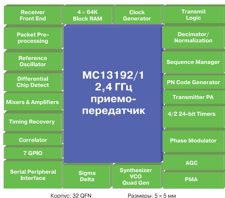
Рис. 5. Структура радиомодема MC13191/2
